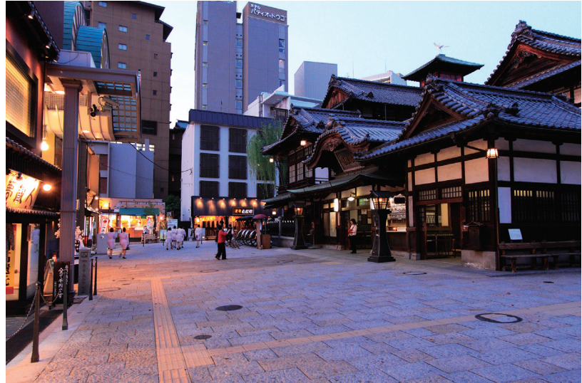
整備後の道後温泉本館正面 石畳は伊予鉄道の敷石に合わせた手加工の御影石(本館正面の一部に本物の敷石が用いられている)
