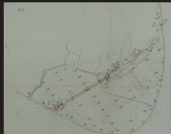
3.工事途中の大正3(1914)年に描かれた計画図 鴉波洗堰は堰長約195mとして、その横には、閘門も描かれている。
