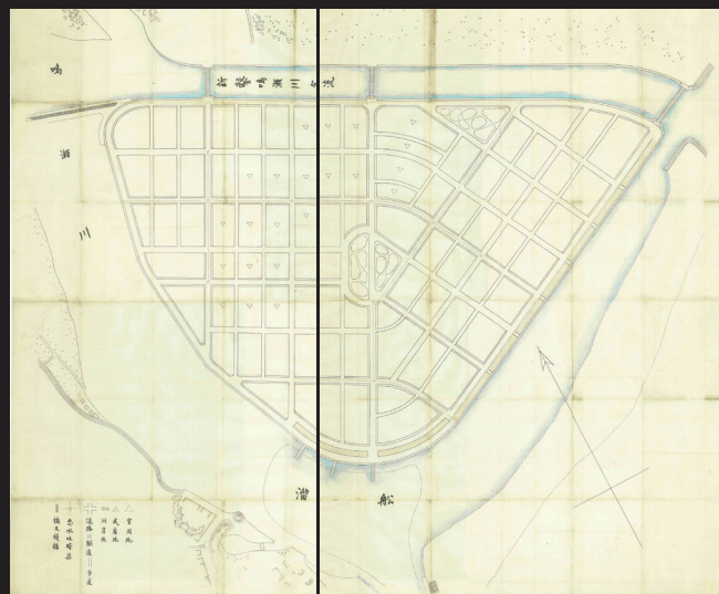
4.宮城県下野蒜市街地之図（野蒜築港の内港および市外計画図） 新鳴瀬川を開削した土砂などで市街地を造成し、10万5千坪（約34.7万㎡）に公園、悪水吐噴渠（下水道）などが配置された。
