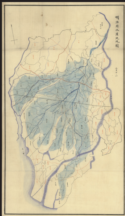
9. 明治用水灌漑地図 上から下へ青い太い線が矢作川。上流部分で地図上左側(右岸側)へ別れて幾多に分岐していく青線が明治用水。一番初めの取り入れ口(頭首工)から導かれた水は、この広大な土地を灌漑する。
